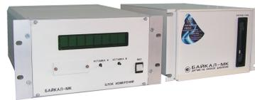
Гигрометр имеет диапазоны измерений объемной доли влаги: 0-1, 1-10, 10-100 и 100-1000 млн<sup>-1</sup>. Основная приведенная погрешность в зависимости от области измерений не превышает: ±10 %, ±4 % и ±2,5 %. Гигрометр может работать при входных давлениях от минус 0,02 МПа до 40 МПа и имеет три типа датчиков: на разрежение, на низкое и высокое давление.
